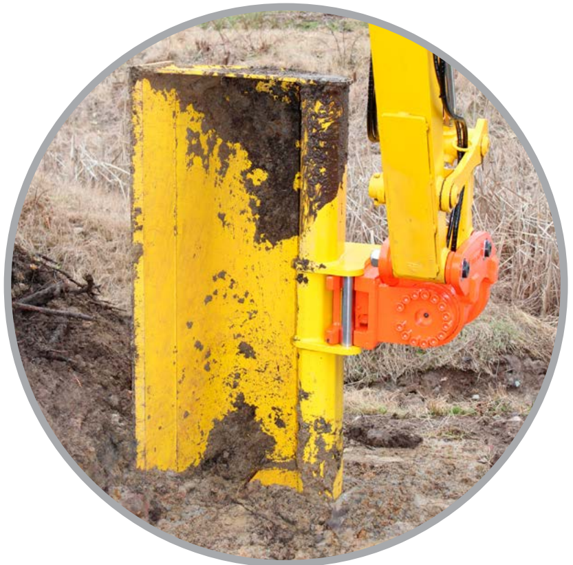
Nettoyage de fossé
